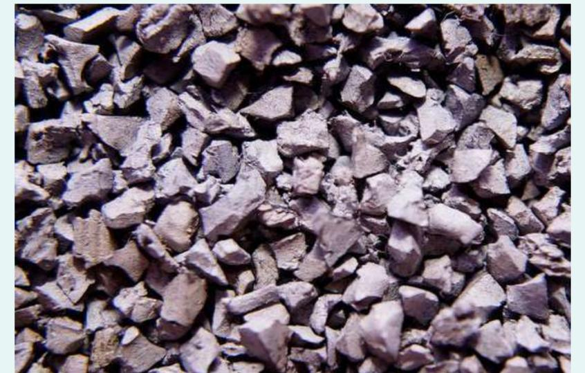
Revestimiento de piso compuesto de 2 capas de caucho granuladas, en el que intervienen dos componentes: SBR, haciendo la función de principal de elemento amortiguador y EPDM o Encapsulado, como capa superficial y de color
